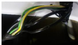
**Faça a medição para identificar qual é o fio de TRAVA e qual é o fio de DESTRAVA.**
