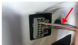
OBS.: o fio vermelho do chicote do MLV608 FF01 deve ser ligado ao positivo (O diâmetro do fio positivo do veículo deve ser no mínimo 1,5mm).
