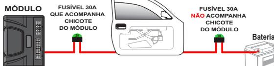
**A FKS recomenda a utilização de um fusível de 30A próximo a bateria para a proteção do circuito elétrico.**
